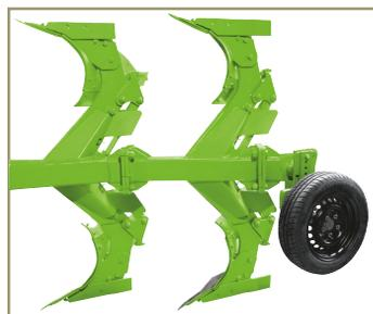
Detalle del sistema de extensión del arado y de la rueda de profundidad.
