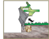
El Shock Control entra en acción y desarma la vertedera.
