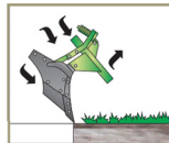
La vertedera se vuelve a armar con la elevación del implemento.
