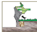
O Shock Control entra em ação e desarma a aiveca.
